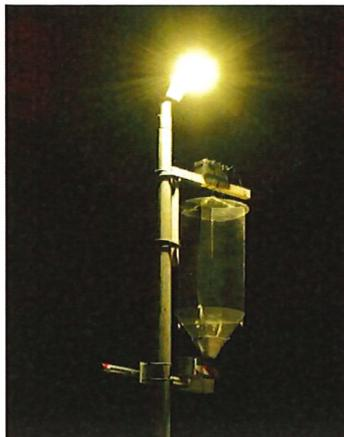
Abb. 4. Automatische Insektenfalle mit einem Batlogger, der Fledermausrufe aufzeichnet.
